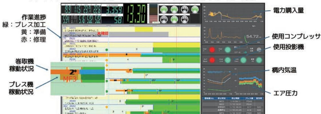
このために当社は、構内60カ所にIoTデバイスとセンサーを設置し、リアルタイムでモニターに表示し管理部門、工場内で状況を共有できるシステムを構築した。作業の進捗は、工場内の4カ所におかれたタブレットで入力する。
