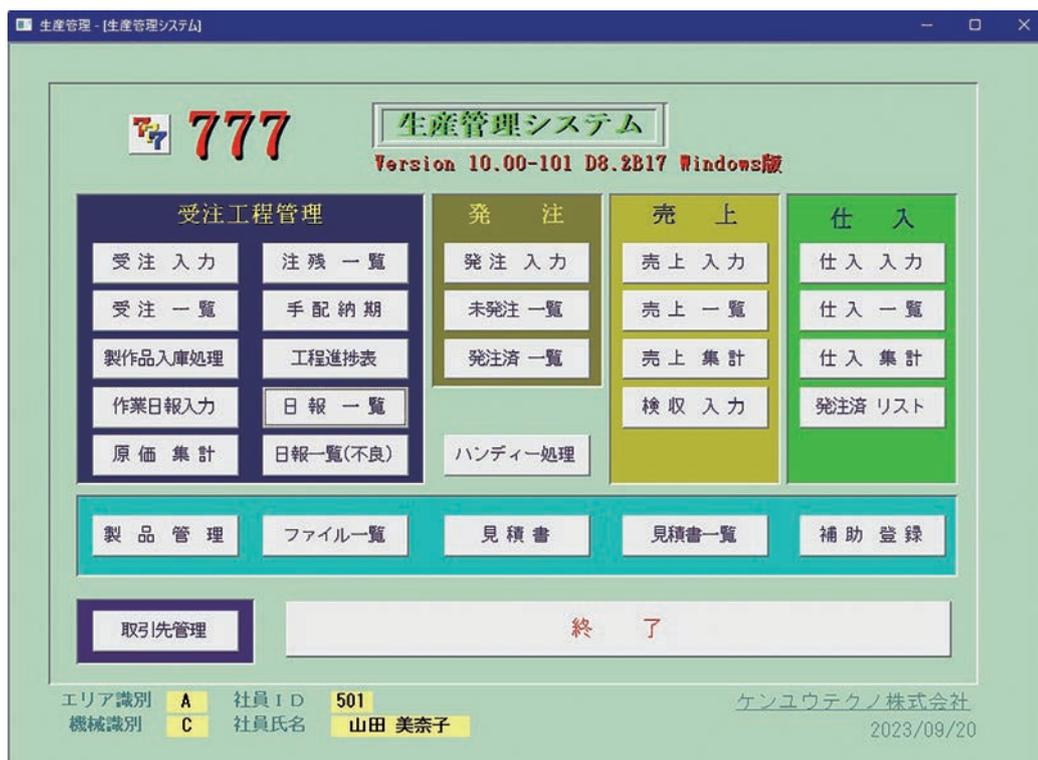
EDIやファックスで受注した情報を、生産管理システムに入力する。システムから出す生産指示書には、バーコードがついており、製造現場の各工程ではバーコードリーダーで読み、着手・終了を入力し、進捗管理が行われる。リピート品は図番を入れると過去のデータから使用した材料・機械、過去のトラブルも付けた情報が示される。毎日、現場リーダーに担当する機械台数分の指示書が届くようになっている。
